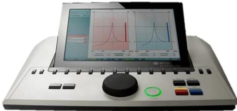
O **AT 235** é um impedânciômetro de diagnóstico de mesa. Sua bateria de testes inclui: timpanometria automática de 226Hz, reflexos IPSI e contralaterais, Decay e Limiar do Reflexo, e Teste de Função Tubária com membrana íntegra ou perfurada (ETF 1 e 2).
